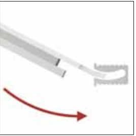
Insertion de l'adaptateur dans la crémaillère Inserting the shelf into the rail
