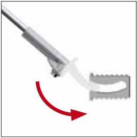
Insertion de l'adaptateur dans la crémaillère Inserting the adapter into the rail
